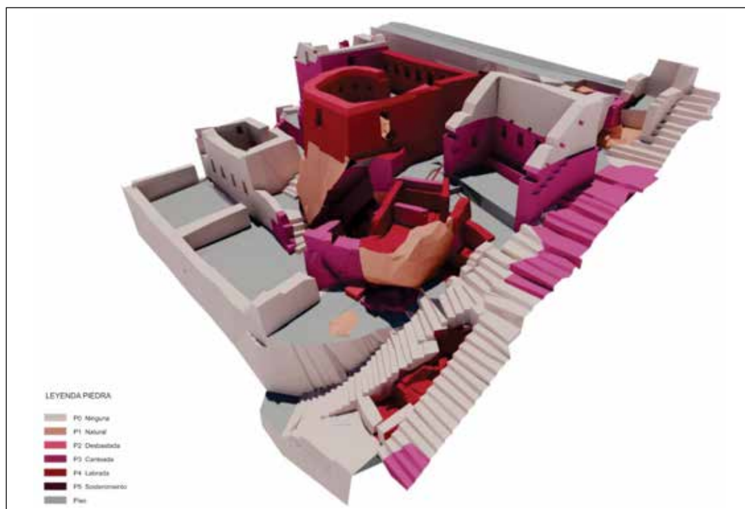
Figura 13. Las dos rocas naturales (en anaranjado claro) determinan el diseño cóncavo y convexo de la construcción sucesiva.
