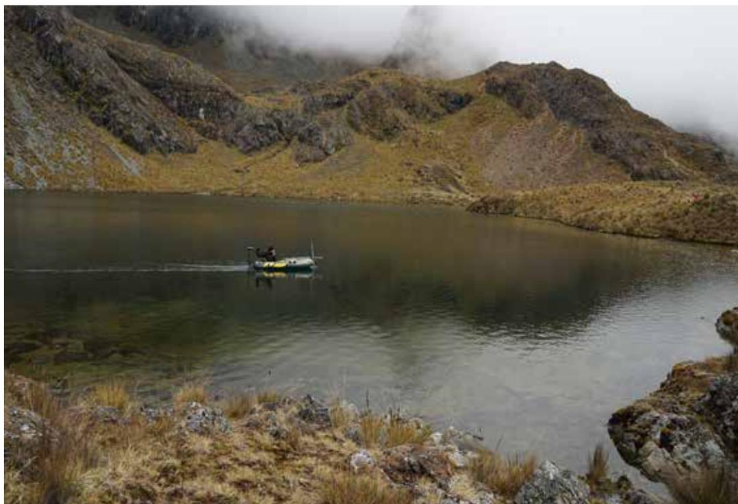
Figura 10. Investigación con sonar lateral y ecosonda en la laguna Soqtaqocha (fotografía: M. Sobczyk).
